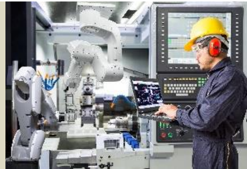
人協働ロボットは比較的小型で、人や障害物を認識できるため柵不要で人と一緒に作業することが可能
